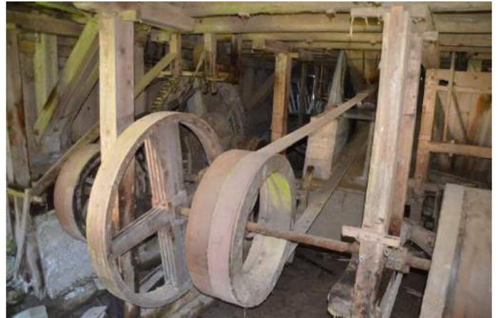
Abbildung 13: Riemenantrieb Weißenbachmühle
