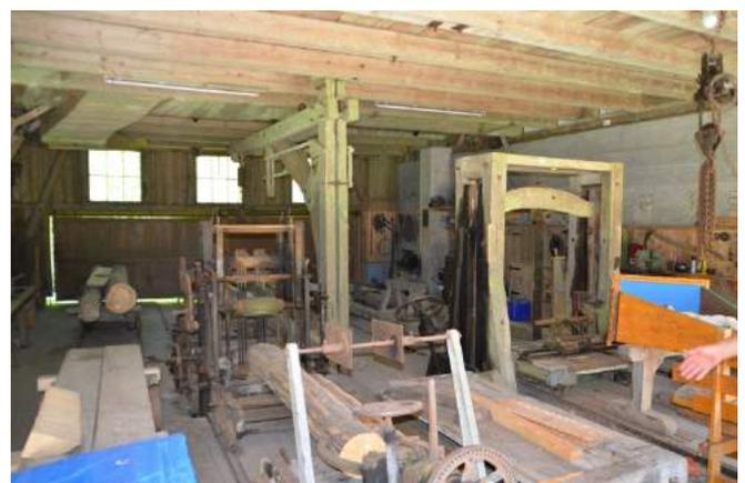
Abbildung 289: Sägegatter der Bruggmühle
