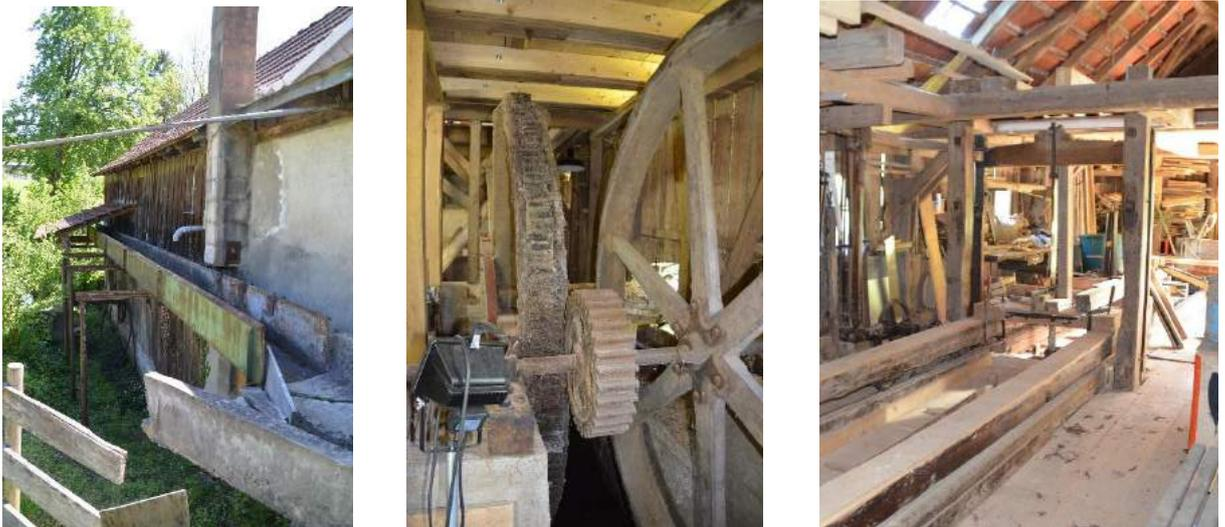
Von links: Zuleitung zum ehemaligen Wasserradstandort, Zahnräder im unteren Teil der Säge, Gattersäge
