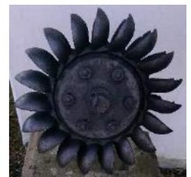
Abb. 8 Pelton-Laufrad, aufgenommen an Triebwerksanlage Oberthalhofen
